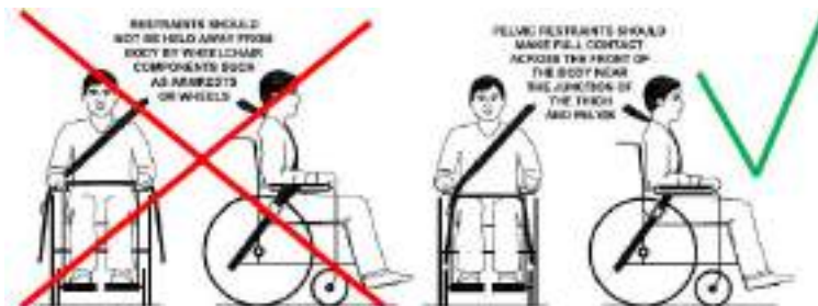
Uso inapropiado cinturón
