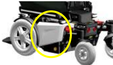
Figura 10-5: Caja de baterías
